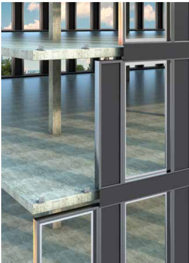
Konstruktionsweise einer Elementfassade
